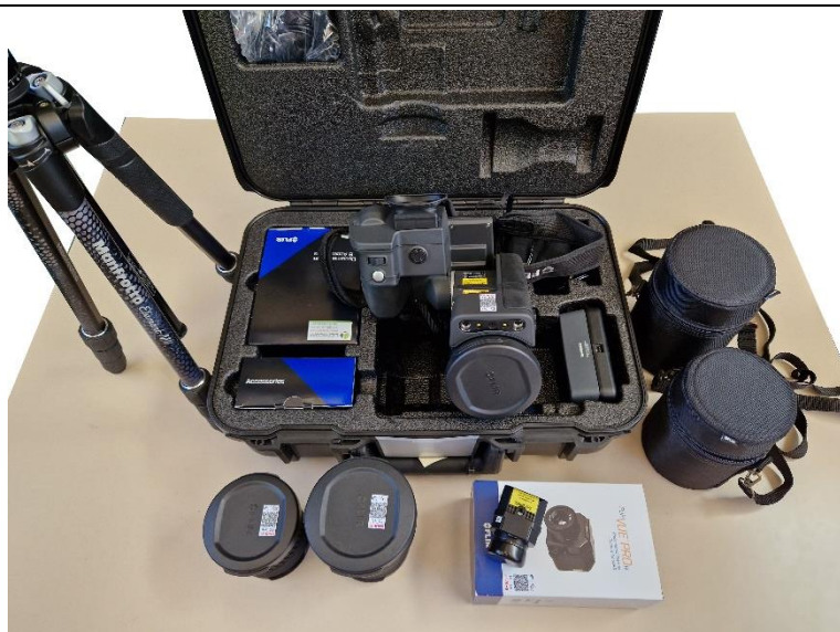
T1020 28° FLIR con ottiche 12° e 45°, FLIR VUE PRO R, treppiede manfrotto di supporto
