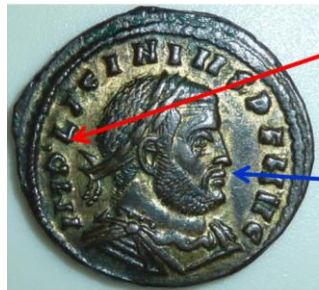
Rivelazione della patina di arricchimento superficiali Ag-Hg spessa 2 micron in una moneta romana composta da Cu-Ag
