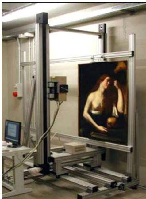
Figura 1: Scanner per radiografie digitali di dipinti
