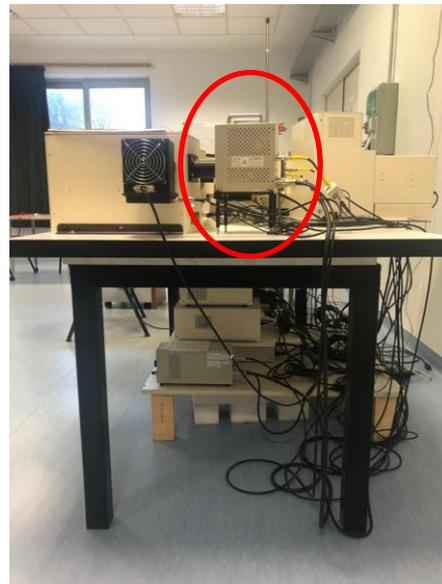
Foto dello spettrofluorimetro che ospita il NIR-PMT (indicato dal cerchio nel riquadro di destra)
