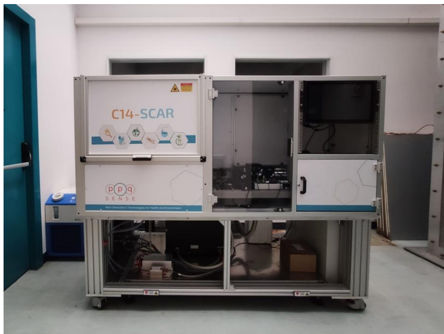
Figura: spettrometro C14-SCAR
