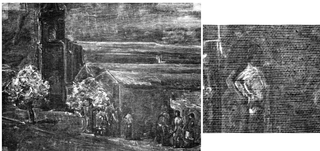
Radiografia di un dipinto moderno di 60x40cm e di un suo dettaglio acquisito in 30s a 30kV e 5mA
