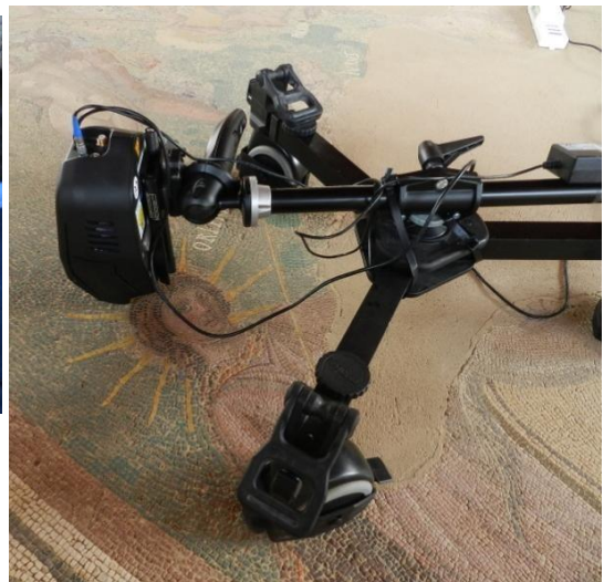
Figura: Condizioni operative dello spettrometro XRF Elio durante misure in situ.
