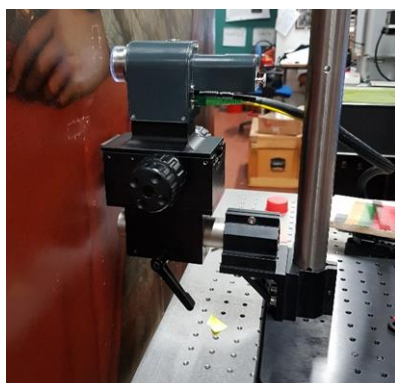
Figura: Testa ottica del dispositivo FD-OCT (a) e TD-OCT (b) durante misure in situ.
