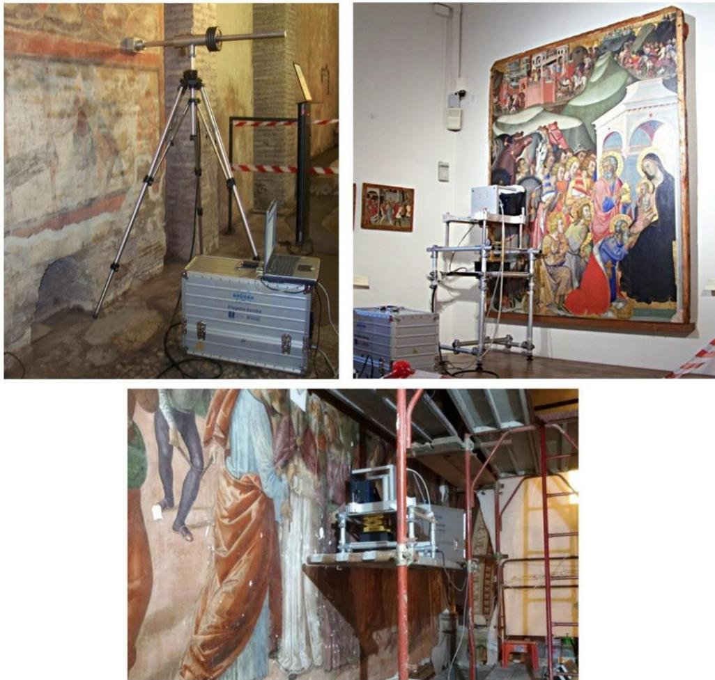
Figura: Condizioni operative del NMR-MOUSE durante misure in situ.
