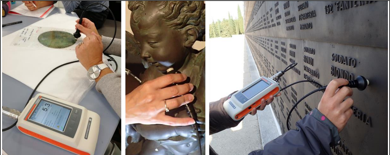
Figura: Rilevazione della conducibilità elettrica su opere di epoca e tipologia diversa.
