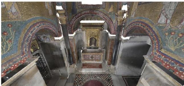
*Santa Prassede, Cappella di San Zenone, Roma. Elaborazione dati laser scanner. Il modello opportunamente trasformato in mesh multi-risoluzione è stato mappato con immagini ad alta risoluzione (texture mapping)*
