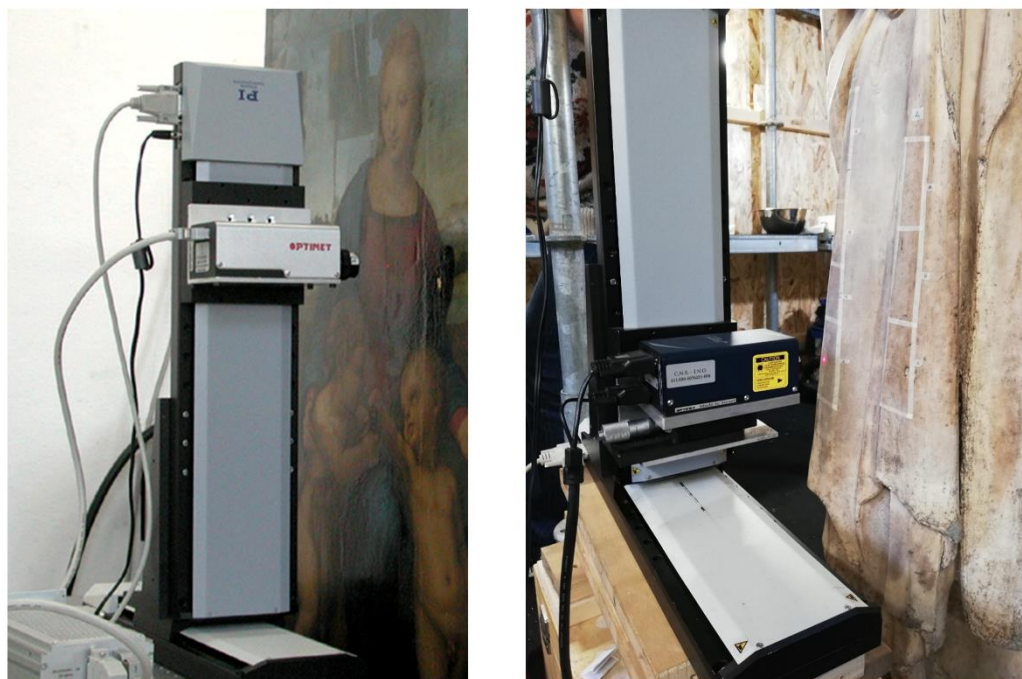
Figura: Microprofilometro durante la misura in situ di un dipinto (sx) e di una statua (dx).
