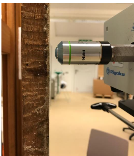
Figura: Condizioni operative dello spettrometro Raman durante misure in situ.
