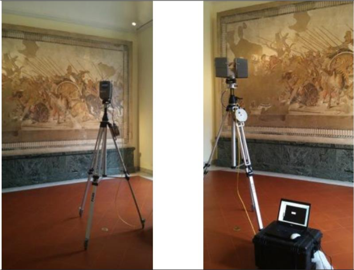
Figura 1: L'acquisizione del modello a media risoluzione di campionamento, operata con uno scanner a interferenza di fase FARO.
