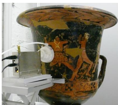
Figura 1: Lo spettrometro portatile PIXE-alfa durante la misura un vaso a vernice nera presso il Museo Archeologico Regionale Paolo Orsi (Siracusa).
