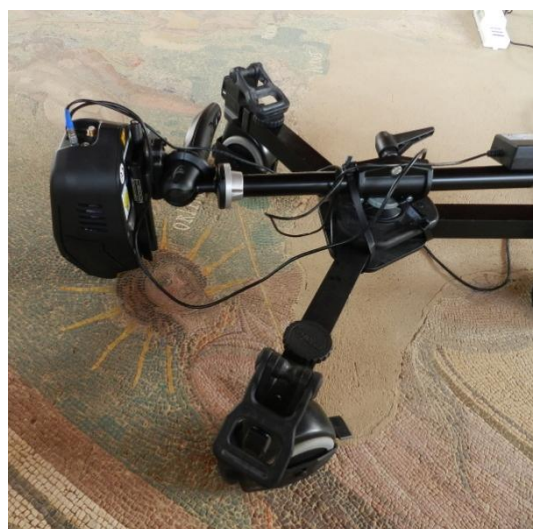
Figura: Condizioni operative dello spettrometro XRF Elio durante misure in situ.
